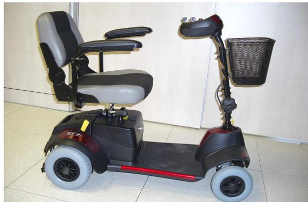
**DESCRIZIONE:** Deluxe mini scooter, realizzato in struttura di acciaio, carenatura in ABS per un utilizzo ottimale e confortevole in spazi ristretti. Telaio innovativo, elegante, di estrema solidità e compattezza (portata massima kg.136). Struttura facilmente e totalmente smontabile per facilitarne il trasporto (peso complessivo kg.47).
