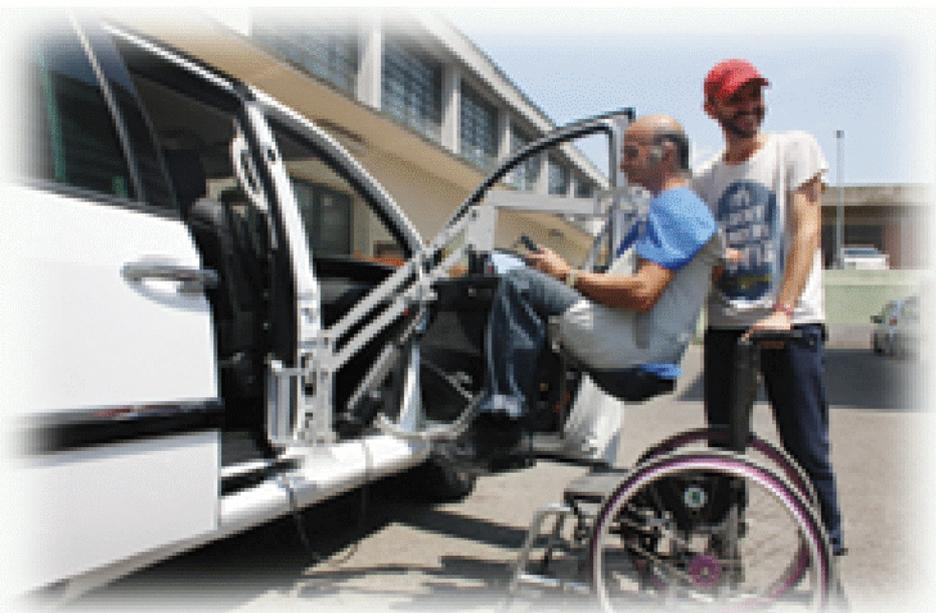
L'installazione della cerniera sul montante del veicolo con porta scorrevole permette l'accesso del disabile con gruetta sia anteriormente accanto all'autista. Sia Posteriormente nella fila centrale.
